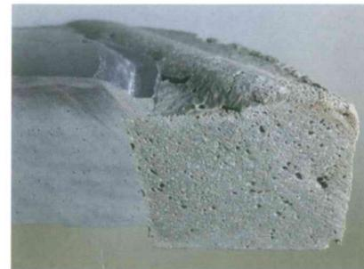
**Bild 2:** Querschnitt eines mit Konudur Robopox 10 fast verpressten Seitenanschlusses
